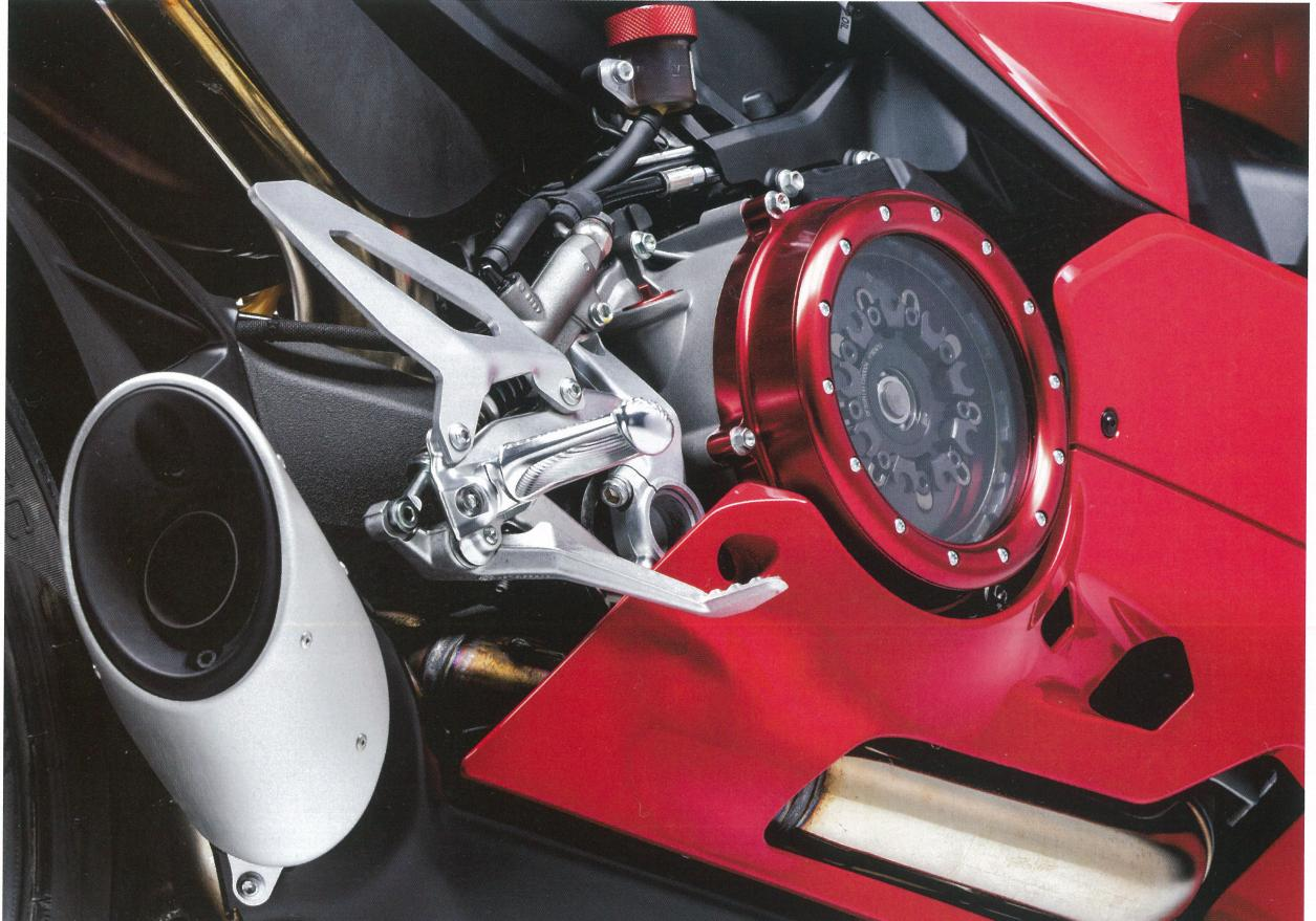
シフトダウンやスロットルOFFでの過剰なエンジンブレーキをコントロール（セッティング可能）する、STMのウェットクリップクラッチを装備。そんなクラッチシステムの動きが見えるスケルトンのクラッチカバーウィンドウが遊び心を誘う
