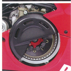
1. トップブリッジは繊細な切削で大いに肉抜きしたモトコルセのオリジナル 2. フットペグをホールド性に優れたCNCラジアルブロック・スクエアエッジに換装。球状のエンドは、靴裏の全方位に高いグリップ力を発揮。モトコルセの人気商品 3. V4RはSTM製の乾式クラッチを装備するため、カーボン製オープンカバーに換装してアビール
