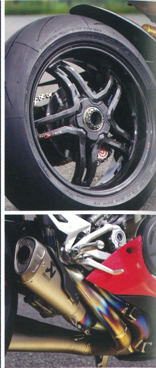
上. プリブレグモノコックカーボンファイバーの5スリットスポークのホイールはBST社のRapid TEKを装着。超軽量な上に金属製ホイールを超える強度を持つ。V4Rはノーマルでも最高出力221hpを誇るが、レースキットのアクラポヴィッチ製のドウカティパフォーマンスのフルエキゾーストを装着すれば1万5,500回転で234hpを発揮!
