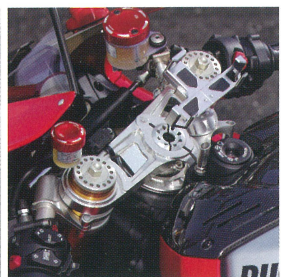
1. トップブリッジは繊細な切削で大いに肉抜きしたモトコルセのオリジナル 2. フットペグをホールド性に優れたCNCラジアルブロック・スクエアエッジに換装。球状のエンドは、靴裏の全方位に高いグリップ力を発揮。モトコルセの人気商品 3. V4RはSTM製の乾式クラッチを装備するため、カーボン製オープンカバーに換装してアビール
