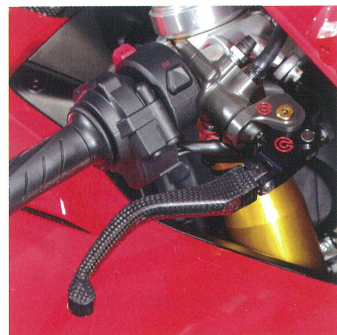
ブレーキクラッチともにブレムボの削り出しラジアルマスターに交換。フールディングレバーはモトコルセのドライカーボンを装着
