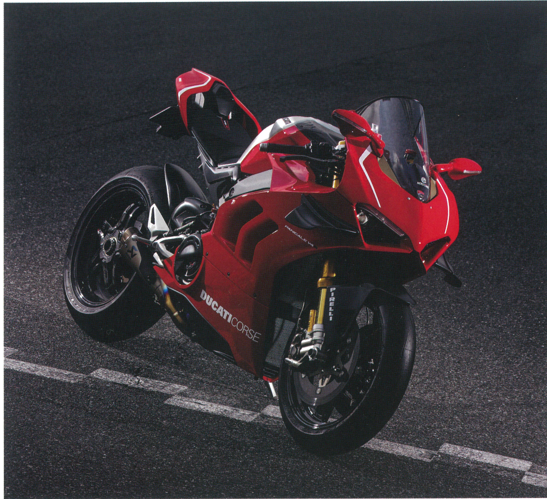
上. プリブレグモノコックカーボンファイバーの5スリットスポークのホイールはBST社のRapid TEKを装着。超軽量な上に金属製ホイールを超える強度を持つ。V4Rはノーマルでも最高出力221hpを誇るが、レースキットのアクラポヴィッチ製のドウカティパフォーマンスのフルエキゾーストを装着すれば1万5,500回転で234hpを発揮!
