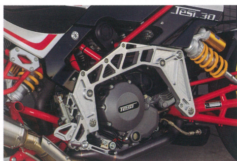
アルミ塊を複雑に切削したオメガプレートが挟み込むエンジンは、ドゥカティ製の空冷2バルブL型2気筒、デスモドロミック機構を持つ1,078ccの「エヴォルツィオーネ」。ドゥカティからのエンジン供給は、'85年のdb1（パンタF1の750ccL型2気筒）から続いた
