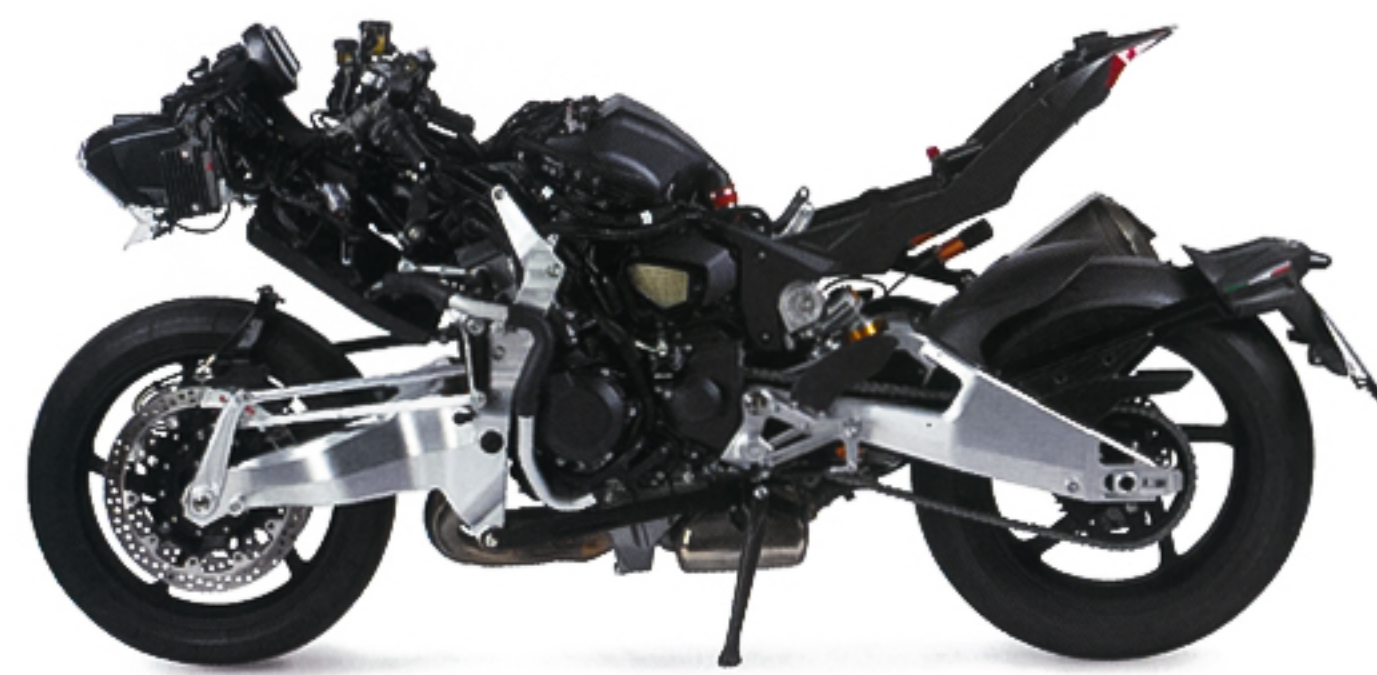
エンジン前部を挟む左右のプレートからFスイングアームが伸び、後部のアルミブロックにRスイングアームを締結
