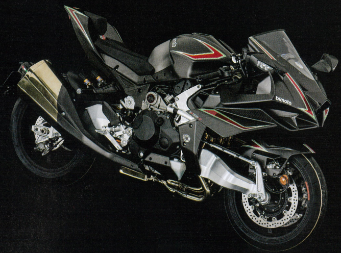
1:スクリーンの奥にあるメーターバイザーには、世界限定生産数250を分母とするシリアルナンバーが刻印されたバッジが飾られる 2:容量17ℓの燃料タンクにもカーボン製カバーが装着され、ライダーと接触する部分はヘアライン加工されたアルミニウムとなっている。高品質素材を巧みに組み合わせることで質感を高めている 3:スーパーチャージドエンジンである証のひとつ、過給ユニットへフレッシュエアを送るインターダクトもカーボン製だ 4:シートフレームもカーボン製でリアフェアリングと見事に調和している。なおシート高は840mmだが、フロントとリアショックユニットに設けられたエキセントリックカムを回転させることで上下に10mmずつ調整可能となっている
