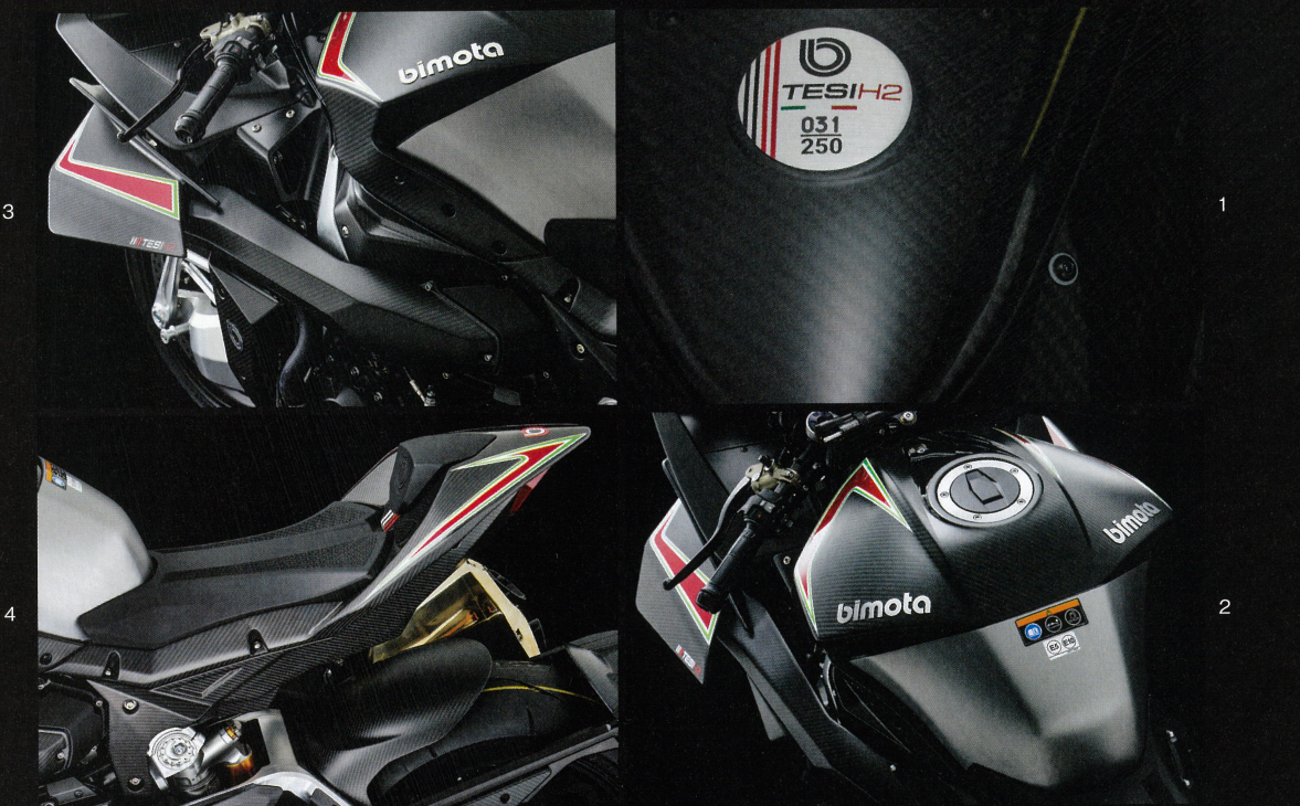
1:スクリーンの奥にあるメーターバイザーには、世界限定生産数250を分母とするシリアルナンバーが刻印されたバッジが飾られる 2:容量17ℓの燃料タンクにもカーボン製カバーが装着され、ライダーと接触する部分はヘアライン加工されたアルミニウムとなっている。高品質素材を巧みに組み合わせることで質感を高めている 3:スーパーチャージドエンジンである証のひとつ、過給ユニットへフレッシュエアを送るインターダクトもカーボン製だ 4:シートフレームもカーボン製でリアフェアリングと見事に調和している。なおシート高は840mmだが、フロントとリアショックユニットに設けられたエキセントリックカムを回転させることで上下に10mmずつ調整可能となっている
