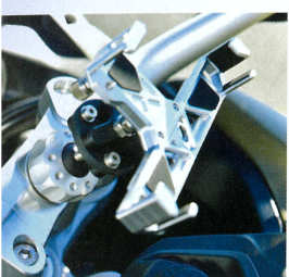
ワイルドな雰囲気だが、モトコルセのユニバーサルマウントシステムによりスマートフォンの車載も可能にしてある
