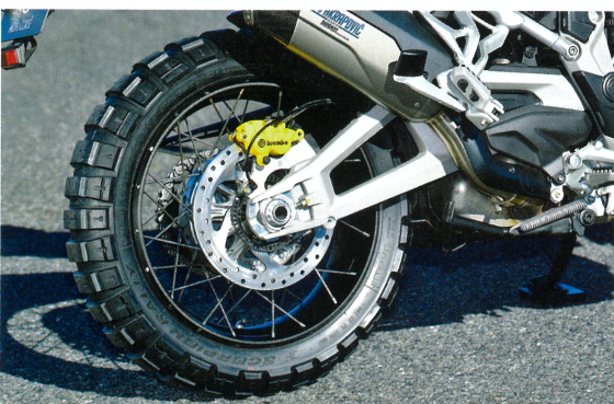
前後ホイールを純正オプションのスポークタイプに換装。タイヤは、ダート走破性を主題に開発されたピレリ製スコピオン・ラリーだ
