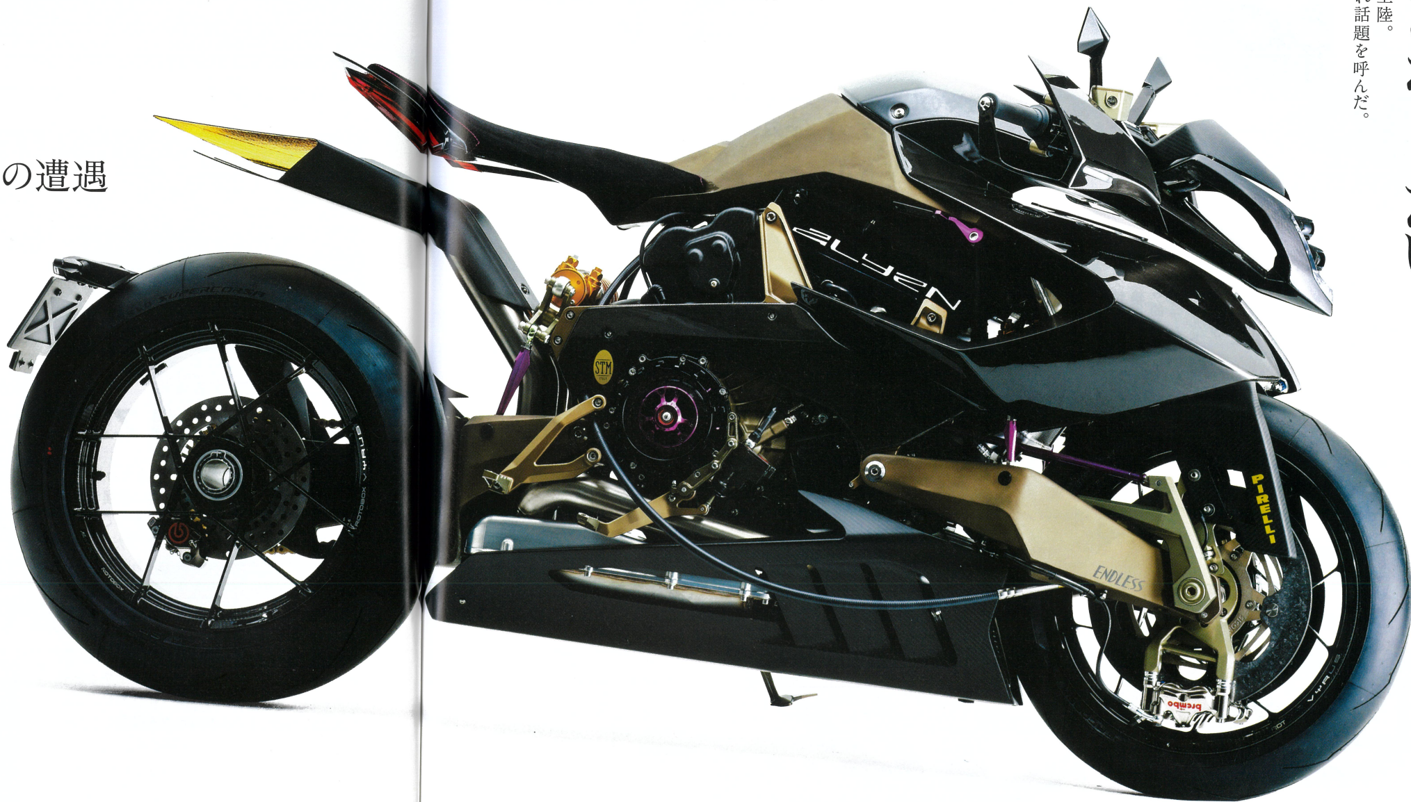
剛性と軽さをさらに向上させるべく、車体から大きく張り出すフェアリングは、カーボン繊維を織り込まず単一方向に揃えた素材を積層させたユニディレクショナル (UD) カーボンを採用している
