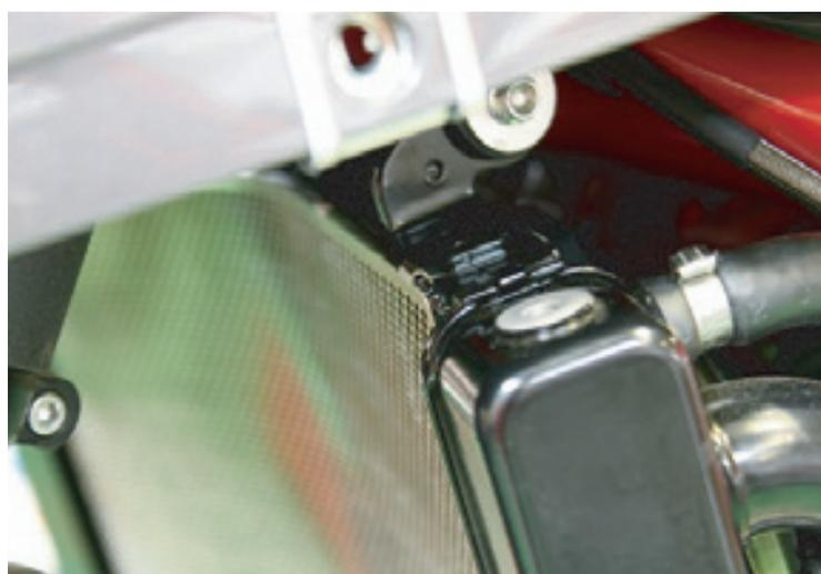
5. ロアラジエターのシュラウドにゴム系接着剤で固定されている網をカッター等を用いて切り離します。
