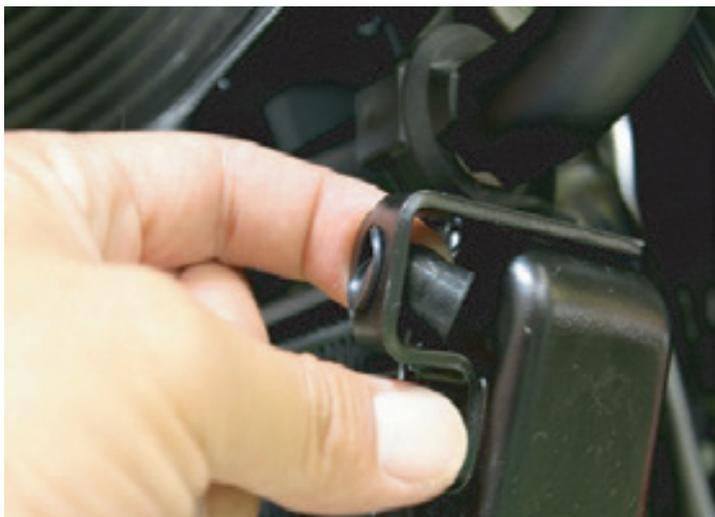
2. プロテクションスクリーンを取り付けてからウェルナットを貫通させます。(ボルトを仮組し中心部を押してください)
