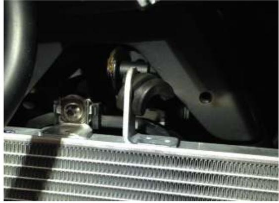
③ラジエーター本体の上下に付属のモールを取り付けます。
