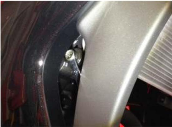
②ラジエーターをずらし上部マウント部をボスから外しグロメットを取り外します。
