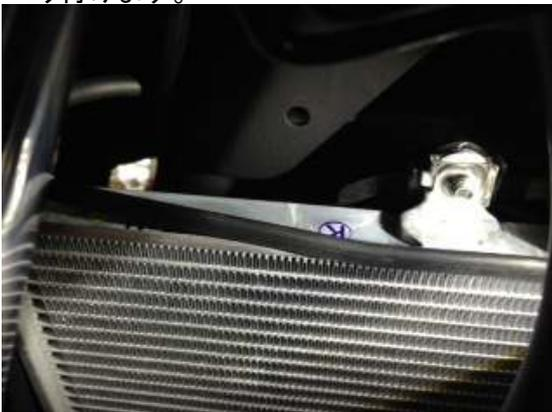
④本製品の下部のフック部分を取り付けたモールにかぶせ確実に奥まで差込ます。
