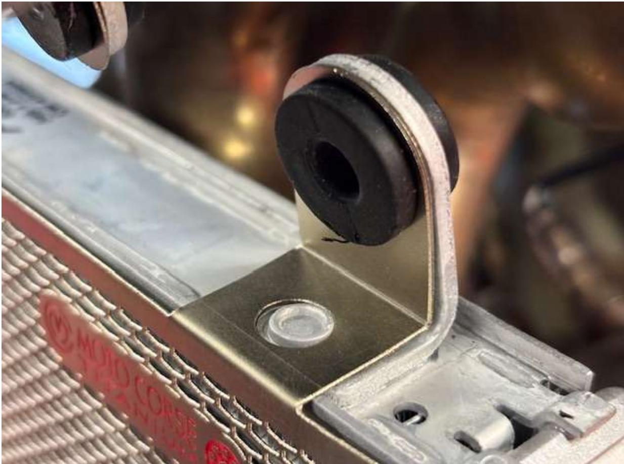
■ 製品下側は画像のように、モールラバーを取付け製品フック部をはめ込みます。
