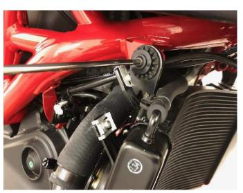
⑥製品の取り付けステーをホース下をくぐらせ ラジエターに沿わせます。
