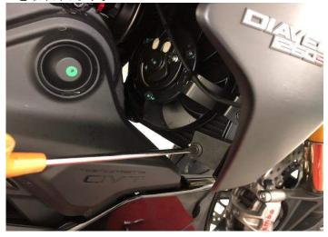
③ラジエター裏のウィンカーの配線カプラーを取り外し ターンインジケーターを取り外します。
