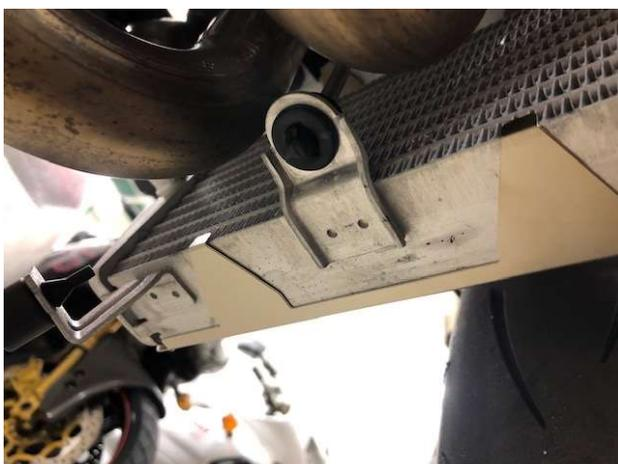
⑭ラジエターとの連結ボルトを固定し、歪みがない確認します。
