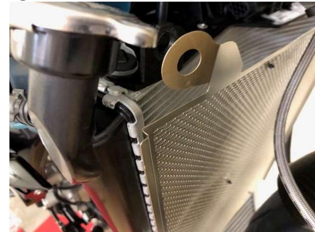
⑨ラジエターに合わせて湾曲させながら段差部分にはめ込み固定します。
