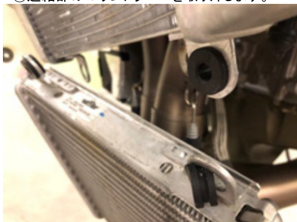
⑱連結部のマウントラバーを取り外します。
